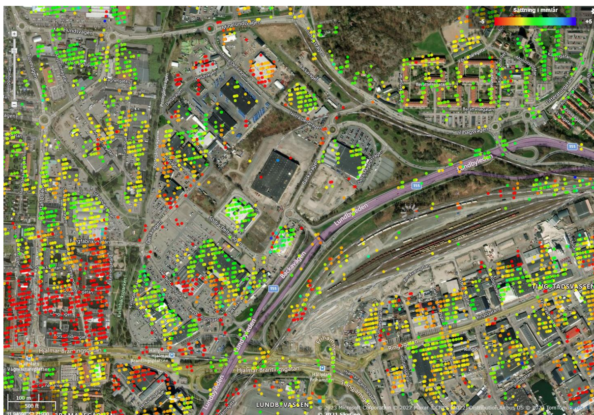
Figur 7-1 Utsnitt från Sättningskartan över området i och kring Backaplan. Ju rödare desto större sättningshastighet. https://sattningskartan.portal.skygeo.com/portal/sattningskartan/u1/viewers/basic/
